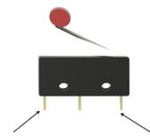
Der so vorbereitete Taster wird in das Taster Gehäuse eingelegt . Die vordere Schraube (M3x20) wird in die bereits eingepresste Mutter eingeschraubt. Die zweite Schraube (M3x20), wird durch den Bogen gesteckt und von innen mit einer Scheibe und Mutter befestigt. Über diesen Bogen wird der Sensor später justiert.
