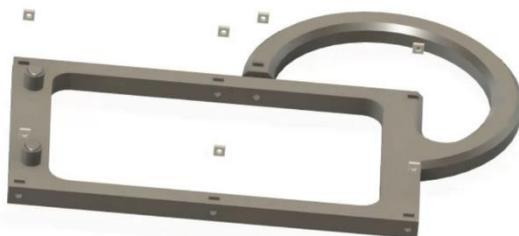
Als nächstes bereiten wir die Grund- oder Bodenplatte vor. Wir schieben 7 M3 Vierkantmuttern ein und fixieren diese gegebenenfalls mit einem Stück Tesa, solange bis sie benötigt werden.
