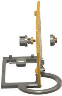
Die beiden **Teile A & B** werden nun in der Zentralplatte über das Kugellager mit der M3x30 Schraube fest verbunden. Die Schraube wird dabei in die Mutter (c) geschraubt, die in der Flanschplatte (d) verklemmt ist.
