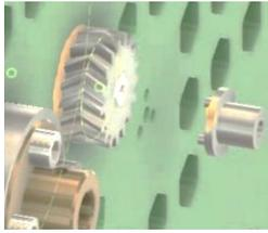
Zunächst stecken wir die Lagerbuchse mit den 3 Pins in die entsprechenden Bohrungen in der Zentralplatte lose ein, wie gezeigt. Danach pressen wir das Lager in das Zahnrad mittig ein, wobei das Zahnrad ca. 0,5 mm übersteht.
