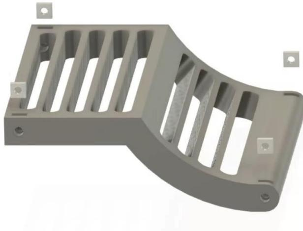
Dieser Schritt ist sehr einfach. Wir legen 4 Vierkantmuttern in die **crossplate** (Querplatte) ein und fixieren diese gegebenenfalls.
