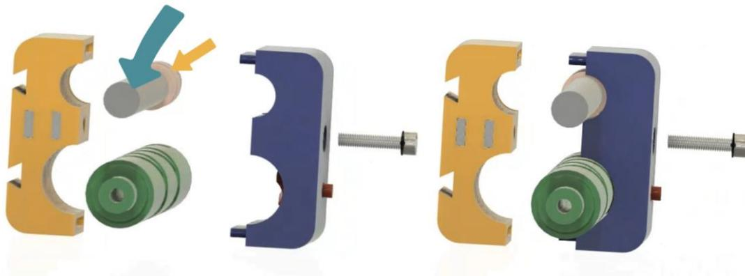
Dazu schieben wir die beiden eingebauten Gleitlager in eine mittlere Position auf der Schiene und schieben danach den blau dargestellten Reiter teil auf die beiden Gleitlager. Wir müssen dabei darauf achte, dass das T Stück richtig platziert ist und in einen Gewingegang der Doppelhelix gelegt wird. Wir pressen beide Reiter teile zusammen. Wenn kein Spalt mehr sichtbar ist und wenn sie sich nicht mehr auf der Wendel hin und herschieben lassen, können wir sie zusammenschrauben.
