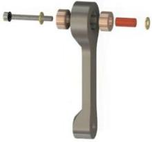
Als nächstes bauen wir den Hebel zusammen. Wir stecken die beiden Kugellager bündig ein, stecken die **nozzle** (Tülle) durch die Lager. Durch die Tülle wird eine Schraube M3x20 mit 2 Scheiben (wie abgebildet) gesteckt.
