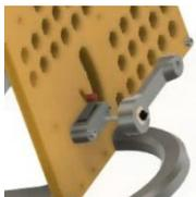
Wir schrauben den Hebel nun von außen fest in die Bohrung oberhalb des Mikroschalters ein und fest.
