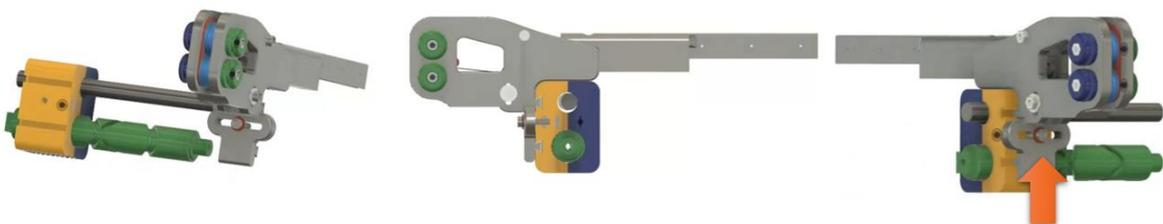
Schließlich schieben wir die Filament Führung mit der Schwalbenschwanznut auf den Reiter und fixieren sie in etwas mittig mit einer M3x8 Schraube inklusive M3/7 Scheibe.
