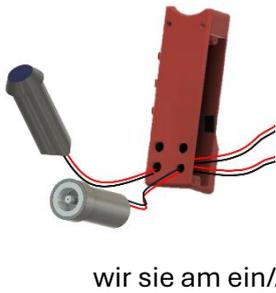
(d) Die LED und die DC Power Buchse sind bereits fertig konfektioniert mit Kabeln, daher müssen wir deren Kabel durch die untere linke (LED) und rechte (DC) Bohrung durchstecken. Danach verlöten wir sie am ein/Aus Schalter.
